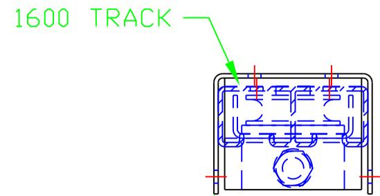
END VIEW OF ADJUSTABLE DEAD END PULLEY
